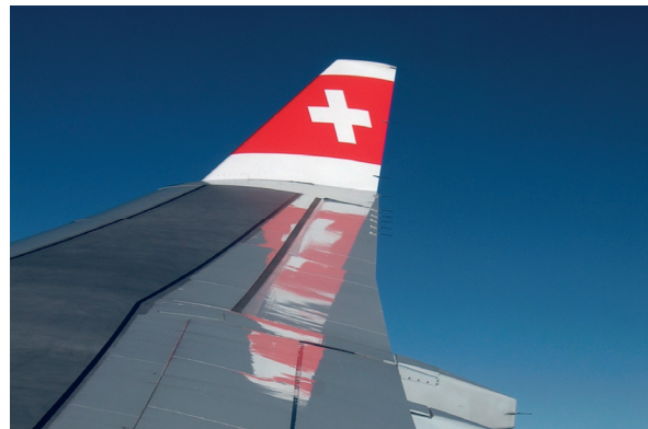
Von den Ingenieuren umgesetzt: Die «Winglets» am Airbus A 340-300. (Foto: M. Simonet)
